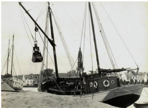
Construite en 1945 au chantier de Keraudren de Camaret, Notre Dame de Rumengol est une gabare grée en dundee de 22 mètres de long et équipée d'un moteur diesel DU-PLEX de 100 chevaux. Le bateau tient son nom d'un sanctuaire marial, implanté sur un site druidique située à Rumengol, autrefois commune à part entière mais aujourd'hui, rattachée à la commune du Faou.
