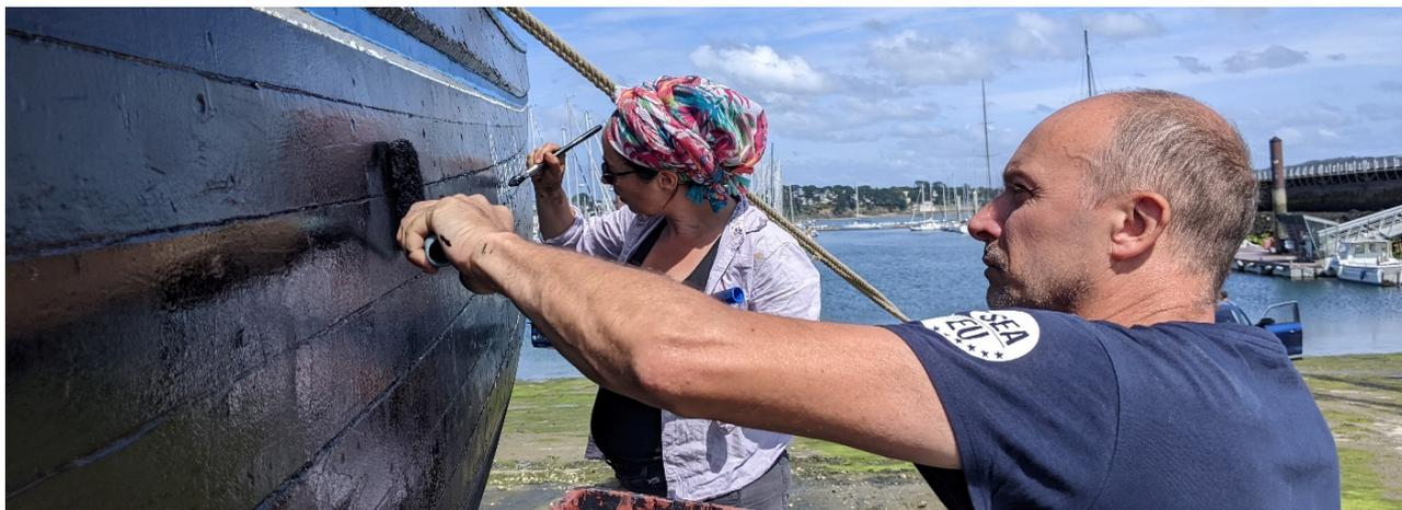
La gabare et le coquillier nécessitent des travaux d'entretien toute l'année. Ainsi, en fin de saison, les bateaux doivent être désarmés (voiles, drisses, poulies et accessoires doivent être démontés, vérifiés, nettoyés et rangés). Enfin, les tauds sont mis en place. Ces manœuvres nécessitent un grand nombre d'adhérents car le matériel est lourd. Puis les bateaux demeurent sur leur aire d'hivernage (Notre Dame de Rumengol à L'Hôpital Camfrout et Bergère de Domrémy au Tinduff).
